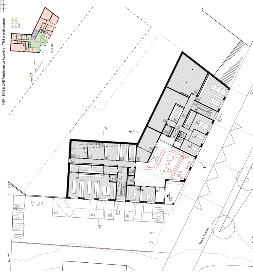
Niveau 0 - Rue du Simplon 1/200 - Alt. = 409.00 / 409.70 0 2 5 10 m
